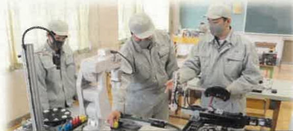
【産業用ロボットの操作】 産業用ロボットをコントローラで実際に動かします。プログラムについても学習します。
