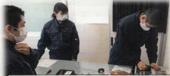
【配線用遮断器とヒューズの特性測定】 過電流が流れた際に発生する事故を防止するための過電流遮断器の特性を調べます。
